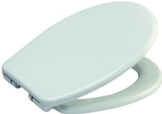
Abattant pour WC à fermeture ralenti en résine thermodurcissable, bactéricide, angle d'ouverture 98°. A installer sur toute cuvette normalisée avec entraxe de fixation de 80 à 170mm, fixation par charnière individuelle réglable en acier inoxydable avec semelles antidérapantes. Facilement déclipsable.
