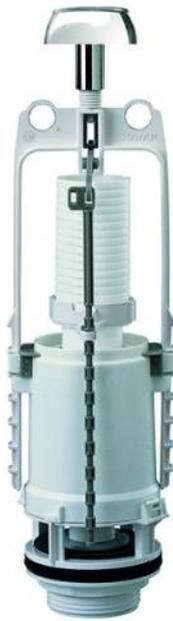
Mécanisme de chasse simple volume, à étrier permettant la fixation du couvercle du réservoir. Bouton auto réglable, bouton et coupelle chromés, chasse interrompable. Hauteur ajustable entre 305 et 415mm, diamètre trou de couvercle compris entre 18 et 50mm, diamètre trou évacuation compris entre 58 et 72mm. Trop plein réglable.
