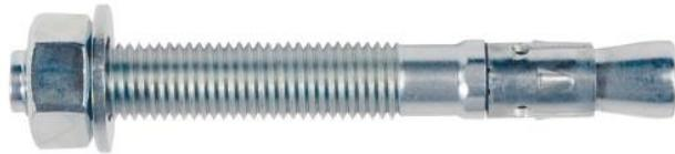
Goujon d'ancrage pour installation traversante et en attente. Le serrage de l'écrou entraîne le cône dans la bague d'expansion et expande cette dernière contre les parois du trou foré. Le goujon FXA en acier électrozingué garantit des charges plus élevées dans un béton non fissuré - le support d'ancrage ne permet pas de charges plus élevées. Temps de perçage réduit grâce à une profondeur d'ancrage réduite.
