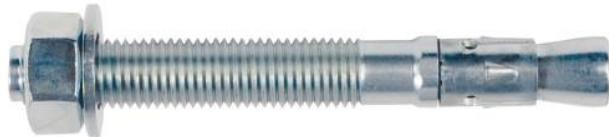
Goujon d'ancrage pour installation traversante et en attente. Le serrage de l'écrou entraîne le cône dans la bague d'expansion et expande cette dernière contre les parois du trou foré. Version en acier inoxydable A4 pour applications en extérieur et en milieu humide. Temps de perçage réduit grâce à une profondeur d'ancrage réduite.
