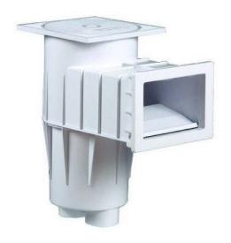
Skimmer rectangulaire à sceller pour piscine, petit bassin ou spa béton (revêtement: peinture, carrelage etsilico-marbreux). Conçu en ABS traité anti UV. Connexion :  $\varnothing$  2" (63 mm) et trop plein  $\varnothing$  32 mm.
