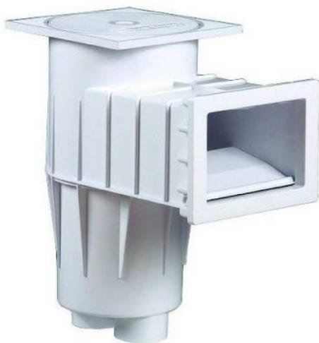
Skimmer rectangulaire à sceller pour piscine, petit bassin ou spa béton (revêtement: peinture, carrelage etsilico-marbreux). Conçu en ABS traité anti UV. Connexion : Ø 2" (63 mm) et trop plein Ø 32 mm.
