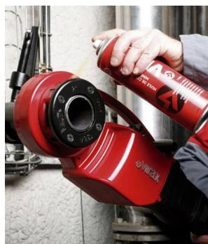
Pratique pour fileter sans effort jusqu'à 2" dans toutes situations. Etau de blocage avec barre anti-couple pour empêcher la rotation de la machine pendant le filetage. Ergonomie adaptée aux filetages contraignants. A double sens de rotation. Inverseur de rotation mécanique garantissant une plus grande longévité du moteur. Adaptateur pour têtes octogonales 1/8" à 1"1/4 avec système unique de verrouillage : maintien sécurisé de la tête lors des filetages contraignants.
