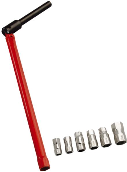
Clé de faible encombrement pour accéder aux écrous peu accessibles. Convient à la plupart des robinets. Embouts et bras creux pour ne pas être gêné par les tiges filetées. Pour le montage et le démontage des robinets et mitigeurs à fixation avec écrou. Bras creux de 25 cm de longueur. Embout creux pour écrous hexagonaux de 13mm.
