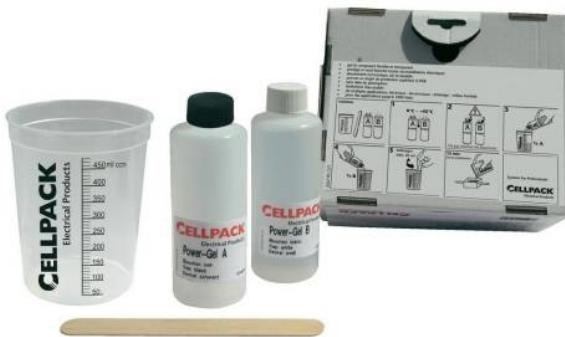
Gel 2 composants, flexible et transparent, avec un ratio de mélange 1 :1. Étanchéifie et protège les installations électriques. Non toxique, propre, de longue durée. Evaluation jusqu'à IP68. Résistance diélectrique > 23 kV/mm. Très haute valeur de résistance (>1016 MΩ x cm). Pour des installations de plus de 1000V. Peut être enlevé, durée de vie permanente si non ouvert. Utilisable jusqu'à 12 mois après ouverture.
