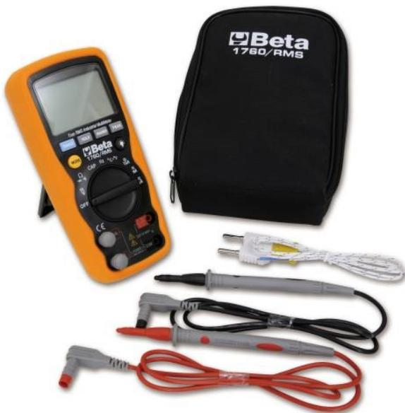
Multimètre digital testé contre les chutes accidentelles jusqu'à 2 m de haut. Étanchéité à l'eau IP67. Protection jusqu'à 1 000V. Entrées protégées. Sélection automatique d'échelle. Afficheur grandes dimensions avec rétroéclairage bleu. Sonde de température de type K (fournie). Extinction automatique. Base en caoutchouc porte-terminal pour un plus grand confort d'utilisation. Pointes à double isolation 1000V, longueur 1m. CAT IV 600V/ CAT III 1000V.
