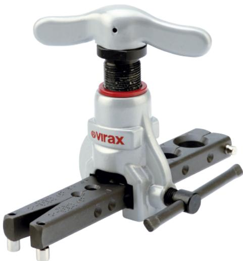
Toupie montée sur excentrique permettant d'obtenir une finition irréprochable pour une étanchéité parfaite. Système de "débrayage" en fin de course permettant un "lissage" du collet. Minimum d'effort grâce à la grande poignée de la vis d'avance. Capacité sur tube cuivre recuit et écrouï, collet conique à 45° : Ø 3/16" à 3/4" OD. Appareil de précision destiné à la réalisation de collets sur tube cuivre frigoriste.
