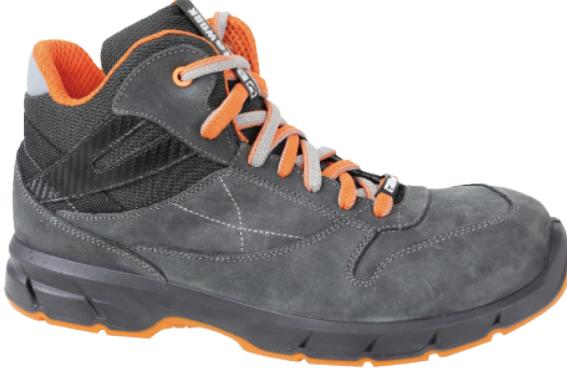
Tige en nubuck hydrofuge avec inserts en microfibre hydrofuge. Semelle polyuréthane double densité. Embout en matériau composite, 200 Joules. Anti-perforation en fibre composite avec traitements céramiques. Semelle intérieure anatomique en polyéthylène + Cambrelle.
