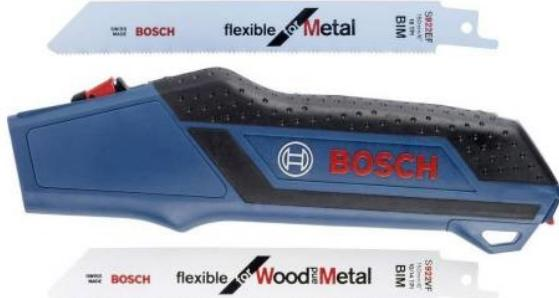
Scie à main pour lames de scies sabres. Scie à main avec emmanchement comptable avec tous les types de lames de scies sabre. Le système de rangement incorporé permet de stocker deux lames. Le système d'emmanchement permet de changer la lame très rapidement.
