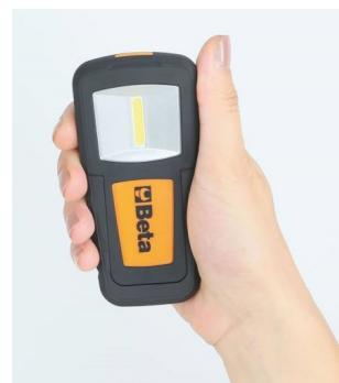
Lampe rechargeable compacte à LED très haute luminosité. Batterie au lithium polymère. Corps compact en caoutchouc antiglisse. Crochet orientable. Clip ceinture. Base magnétique orientable à 180°. 2 puissances lumineuse : 55/110 lumens. Autonomie 5/2,5 heures. IP 20.
