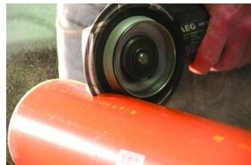
Disque spécialisé dans le tronçonnage de la fonte et du PVC avec chanfreinage simultané. Contour galvanisé. Support diamanté conique pour chanfreiner. Butée de profondeur. Guidage constant. Coupe rapide, gain de temps. Simple d'utilisation. Longue durée de vie. A utiliser avec une meuleuse angulaire.
