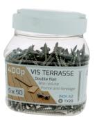
Vis terrasse double filet inox A2, avec tête réduite et pointe cutting. Pointe Cutting évite l'éclatement et la déformation du bois, pré-perçage nécessaire sur bois durs. Double-Filet: améliore le réglage et le maintien de la lame sur la lambourde. L'empreinte Torx 20 profonde offre encore plus de performance avec un meilleur maintient et une transmission plus efficace du couple de serrage.
