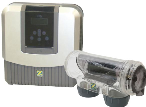
Votre électrolyseur Zodiac TRI traite l'eau de votre piscine de façon naturelle et va ainsi limiter l'utilisation de produits chimiques comme les galets de chlore. Son principe peut se résumer en 3 étapes: L'eau légèrement salée traverse la cellule d'électrolyse et transforme les molécules de sel en chlore actif naturel appelé hypochlorite de sodium, un désinfectant puissant instantanément dissout dans l'eau qui permet de lutter contre les bactéries, les algues et les microorganismes.
