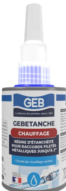
Résine d'étanchéité anaérobie au PTFE assurant l'étanchéité des raccords filetés métalliques coniques ou cylindriques. Étanchéité des circuits de chauffage central (eau froide, eau chaude, eau glycolée, eau additivée). Étanchéité des hydrocarbures de chauffage (fuel, mazout,...). Étanchéité des circuits d'air comprimé, de vapeur d'eau... Non démontable.
