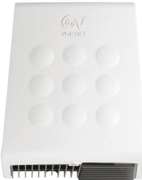
Sèche-mains automatique. Coque en ABS anti-UV. Démarrage automatique par détection infra-rouge des mains dans la zone de séchage. Grille en polypropylène. Arrêt automatique. Seulement 3 vis de fixation. Démontage aisément pour la maintenance. Filtre anti-poussière. Alimentation 230 VAC. Protection IPX4. Dimensions : 253x319x220mm
