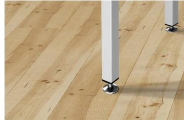
Vis de réglage en acier avec base en caoutchouc antidérapante. Réglage de 12 à 18 mm. Dimensions : M10 x 29 mm.
