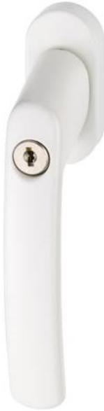
Poignée de fenêtre verrouillable à clé. Conforme à la norme DIN 18267-FG – S2. Impose une forte résistance à l'arrachement et à la torsion. Carré de 7mm. Cylindre avec clé reproductible. Pour fenêtres s'ouvrant vers l'intérieur et l'extérieur. Étudiée pour la sécurité des enfants.
