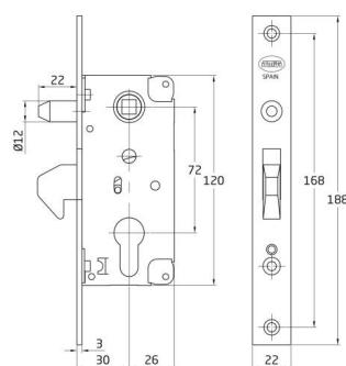
Serrure à encastrer pour menuiserie métallique avec guide et pêne dormant avec crochet de fermeture. Logement pour cylindre profil européen de came de 15 mm. Entreaxe: 72 mm. Carrée fouillot de 8 mm. Tête et gâche en acier zingué.
