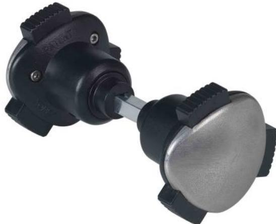
Bouton de sécurité en polyamide et acier inoxydable, pour tout type de serrure avec carré de 8mm. Evite l'accès aux enfants, il est nécessaire d'appuyer sur un des ergots et de tourner, double action simultanée. Avec tige 90mm.
