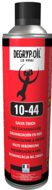
Peinture de protection anticorrosion, à séchage rapide, à base de poudres métalliques pour la finition ou la retouche de toutes pièces métalliques. Bonne résistance aux produits chimiques (sauf acides forts), aux intempéries et à la corrosion. Pour toute surface métallique nécessitant la protection d'une galvanisation : fer, acier, galvanisé et alliages légers. Ne pas appliquer sur des surfaces soumises à des températures >400°C.
