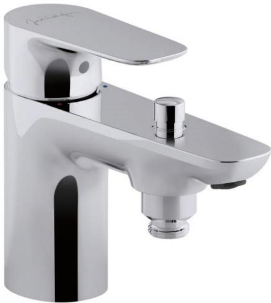
Mitigeur bain-douche monotrou. Inverseur automatique à bouton-poussoir. Flexible d'alimentation équipés de manchons acoustiques. Aérateur discret et anti-calcaire intégré : démontage facile sans outil spécifique (pièce de monnaie) et nettoyage facilité. Flexibles tournants : fixation du robinet facilitée, pas de problèmes de flexibles détachés. Clapet anti-retour sur la sortie douche. Cartouche à disques céramique. Avec flexibles d'alimentation 500mm.
