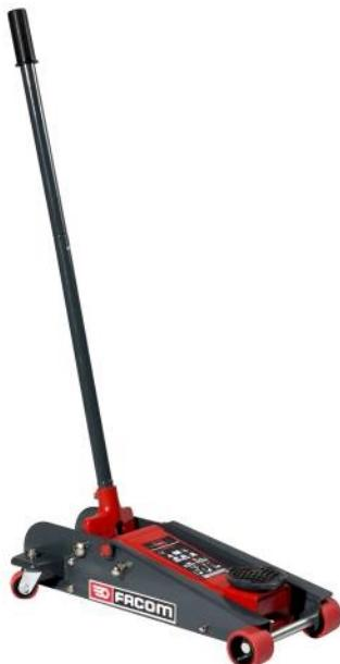
Dispositif de montée rapide : au contact en un mouvement. Dispositif de purge d'air automatique pour une efficacité permanente du vérin. Protection polyuréthane amovible sur tête d'appui. Roues bandage polyuréthane silencieuses. Valve de surcharge.
