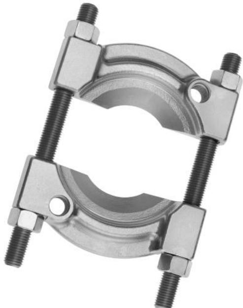
Décolleur permettant de décoller les roulements lorsque les griffes des extracteurs ne peuvent pas passer. Pour terminer l'extraction, les décolleurs sont utilisés avec des potences taraudées.
