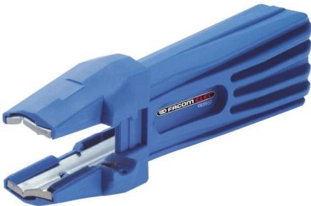
Idéal pour le dégainage des câbles au fond des boîtes d'encastrement. Permet de dégainer et dénuder sans réglage préalable. Permet aussi le dénudage des câbles coaxiaux. Dégainage: diamètre 4 à 13mm. Dénudage: section 0,5 à 16mm<sup>2</sup>. Câbles coaxiaux : diamètre 4 à 8mm.
