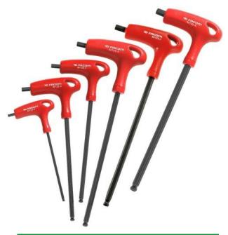
Poignée en T ergonomique pour l'utilisation efficace des deux extrémités de la clé. La tête sphérique permet le vissage avec une inclinaison jusqu'à 30°. Pour serrer, utiliser le 6 pans court. Acier au silicium. Finition polie, phosphatée. Dimensions : 4, 5, 6, 7, 8, 10mm.
