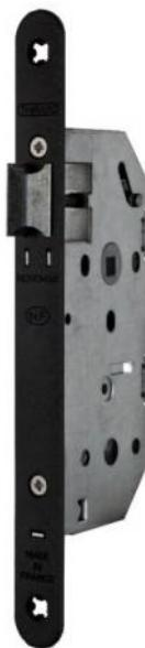
Coffre en acier embouti galvanisé. Trous de passage des fixations rosaces au fouillot et au cylindre. Tête à bouts ronds époxy noir. Pêne demi-tour double galbé réversible. Pêne dormant zingué blanc. Fouillot carré de 7mm. Entraxe 70mm. Livré avec 1 clé pour le pêne demi-tour, livré sans gâche.
