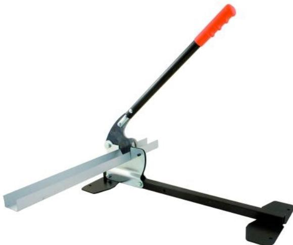
Guillotine pour profilés métalliques. Pour couper rapidement et sans bavure les rails et montants de 48 mm, cornières d'angles, suspentes en T et montants F530 avec l'accessoire de coupe. Gain de temps. Pas de nuisance sonore. Pas d'étincelle, pas de limaille d'acier.
