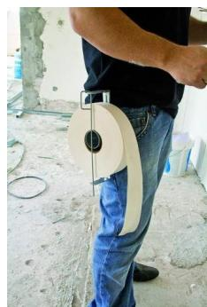
Permet de dérouler et transporter la bande à joint. Brochable à la ceinture. Facilité de chargement des rouleaux. Traitement époxy.
