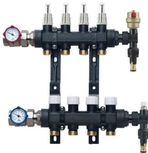
Kit de collecteurs 1" polymère. Mise en place dans les coffrets de profondeur 88mm. Entraxe du raccordement d'alimentation 50mm. Sorties en 3/4" Euroconus. Plage de température 5 °C à +80 °C. Pression de fonctionnement maxi 8 bar.
