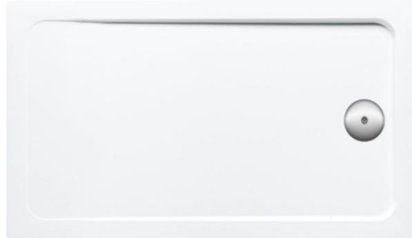
Receveur en acrylique renforcé charge minérale. Installation à poser ou à encastrer. Très robuste par l'utilisation d'une résine bi-composants recouverte d'une feuille d'acrylique. Acrylique traité antibactérien dans la masse. Excellent compromis entre solidité, résistance et poids. Livré sans bonde, diamètre 90mm.
