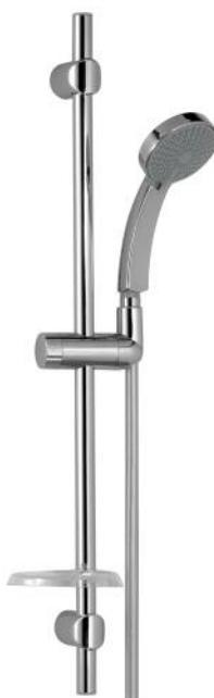
Ensemble de douche avec barre métallique de 0,60m et porte-savon. Flexible anti-torsion 1,60m, gaine lisse aspect métal. Douchette à main 90mm - 4 jets. Système anti-calcaire.
