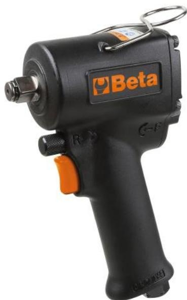
Extrêmement compacte et puissante (770Nm). Mécanisme à simple frappe. Commande d'inversion à touche actionnable d'une seule main. Trois niveaux de réglage de la puissance de vissage. Echappement de l'air par la poignée. Crochet pour potence.
