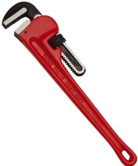
Clé Viragrip pour tubes. Manche et tête renforcés pour une utilisation dans des conditions extrêmes de serrage. Mâchoire mobile en acier forgé traité, doté de 2 ressorts permettant un auto-serrage efficace du tube et assurant des reprises identiques à celles d'un cliquet. Double trempe haute fréquencesur la denture. La mâchoire fixe peut être remplacée.
