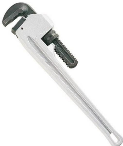
Mâchoire mobile en acier forgé traité, dotée de 2 ressorts permettant un auto-serrage efficace du tube et assurant des reprises identiques à celles d'un cliquet. Double trempe haute fréquences sur la denture.
