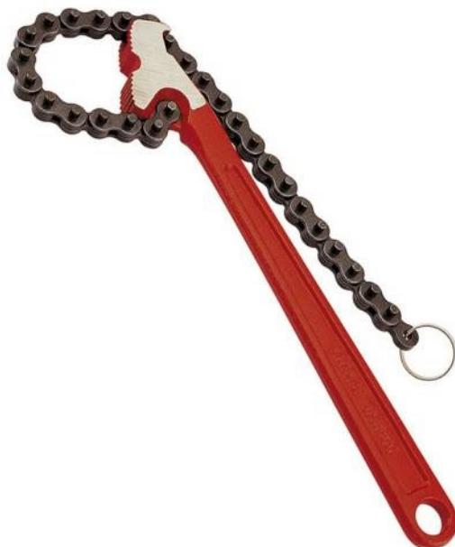
Manche et mors monobloc en acier au chrome vanadium forgé et traité. Double denture permettant d'inverser le sens de serrage sans changer la clé de position. Outil maniable destiné aux montages en espaces restreints.
