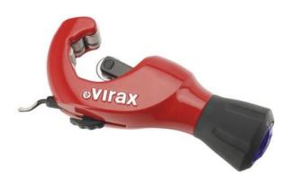
Pommeau Soft Touch® à avance/retour rapide et antidérapant. Changement de molette rapide et sans outil. 4 rouleaux pour un guidage parfait du tube. Epaisseur maxi 3mm. Ebavureur rotatif rétractable à lame interchangeable. Livré avec une molette de rechange.
