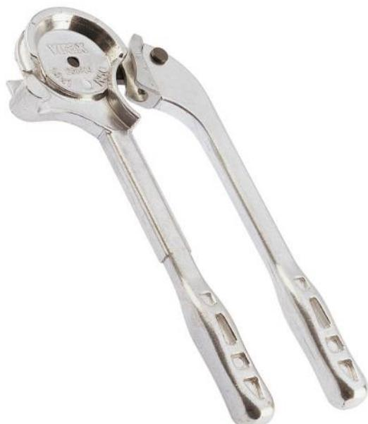
Pour tube cuivre écroui et recuit épaisseur 1 à 1,2mm. Rayon de cintrage environ 3,85 D. Corps en alliage léger. Arrondi permettant l'appui du genou. Angle de cintrage jusqu'à 180°. Zone de serrage en étau parallèle.
