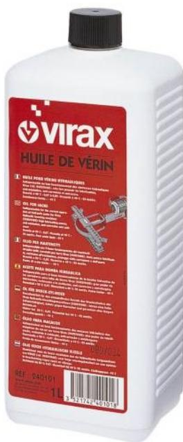
Huile minérale hydraulique hautement raffinée, indispensable au bon fonctionnement des cintreuses hydrauliques. Très fort pouvoir de lubrification, anti-oxydation, anti-corrosion et anti-usure. Densité à 20°C : 0,87 à 0,89. Viscosité à 40°C : 22 mm<sup>2</sup>/s. Écoulement limite : - 42°C.
