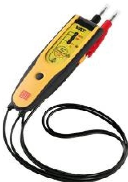
Vérificateur d'absence de tension pour interventions élémentaires, conçu spécialement pour les non électriciens. Son plastron simplifié permet une utilisation simple et sûre. Il permet : de détecter la présence de tension par signal sonore et lumineux, le contrôle des niveaux de tension de 50 à 400V en alternatif (fonctionne également en continu).
