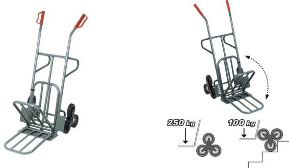
Idéal pour monter ou descendre les escaliers. Diable en métal peint époxy. Axe de roues et bavette renforcés. Équipé de 2 poignées en plastique moulé. Transport par basculement sur l'axe de roues. 3 roues en nylon Ø 140 mm par côté. Bavette rabattable 520 x 330 mm.
