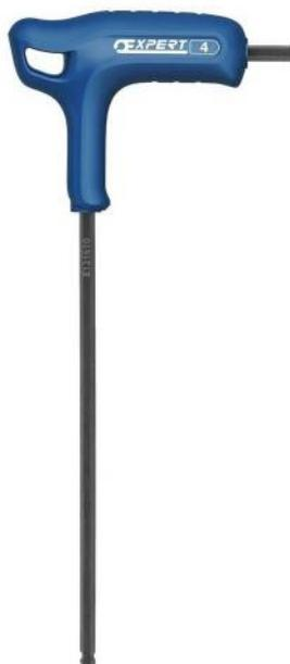
Poignée en T ergonomique pour une utilisation efficace des deux extrémités de la clé. Tête sphérique permettant une inclinaison jusqu'à 15°. Acier au silicium, finition phosphate noir.
