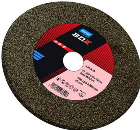
Pour l'enlèvement, de façonnage et l'ébavurage de l'acier courant. Oxyde d'aluminium haute qualité associé à un liant vitrifié tenace. Granulométries et duretés adaptées à l'utilisation. Meilleure coupe, pour un travail plus rapide et une durée de vie accrue. Alésage 32mm.
