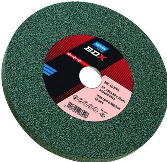
Pour toutes applications, sur tourets d'établi ou sur socle, pour inox difficile, titane et carbure métallique. Carbure de silicium vert. Granulométries et duretés adaptées à l'utilisation. Rapidité d'exécution et meilleure finition sur inox difficile, titane et carbure métallique. Alésage 32mm.
