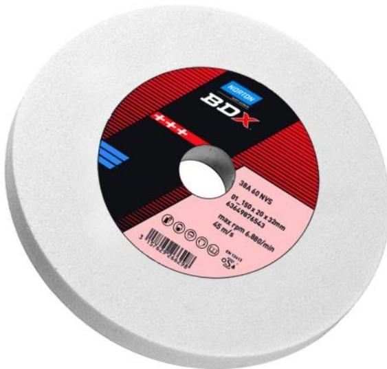
Pour l'enlèvement de matière léger et l'affûtage des outils en acier rapide et acier rapide supérieur. Meilleure finition. Oxyde d'aluminium haute qualité associé à un liant vitrifié performant. Granulométries et duretés adaptées à l'utilisation. Optimisation de la coupe et travail à basse température sur aciers trempés ou aciers rapides. Alésage 32mm.
