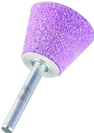
Meule sur tige de 6mm en oxyde d'aluminium rose. Très polyvalent. Contient une faible proportion d'oxyde de chrome. Réduction de la fréquence de dressage. Bonne tenue de la forme.
