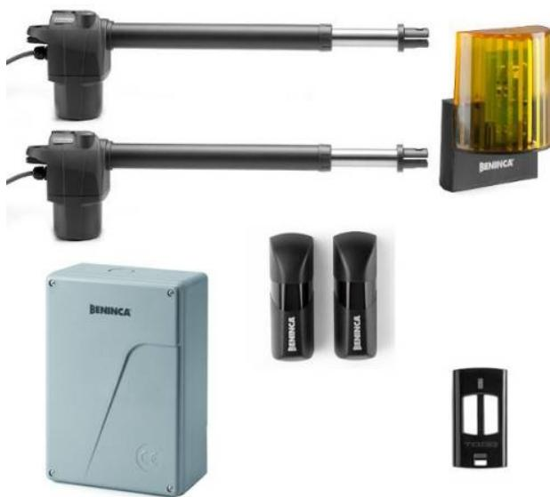
Le kit BILL50M peut motoriser un portail double jusqu'à 10m et 250 kg par vantail ou 4m et 700 kg par vantail, ouverture à 110°. Design et lignes essentiels particulièrement adaptés pour des portails en fer forgé. Facile et rapide à installer grâce à des encombrements et niveaux d'installation réduits. Vitesse d'ouverture réglable.
