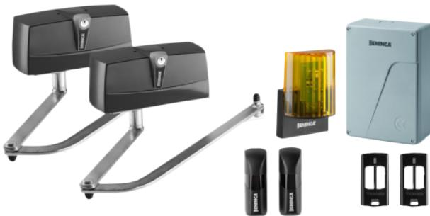
L'automatisme de portail battant KPR45 est un motoréducteur autobloquant qui s'adapte sur des piliers de grandes dimensions, peut motoriser un portail double jusqu'à 6m (2x3m) et 400kg par vantail. Bras articulé robuste anti-cisaillement en acier galvanisé. Fins de courses électromécaniques d'ouverture et de fermeture incorporées. Moteur compact, design horizontal très discret. Equipé d'un déblocage rapide avec clé personnalisée.
